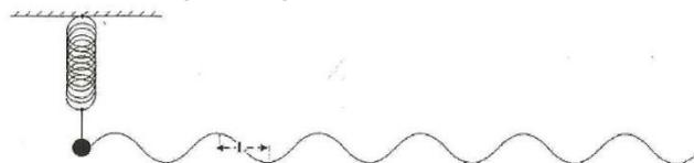
Uma mola ideal tem uma de suas extremidades presa ao teto e a outra a uma esfera de massa  $m$  que oscila em movimento harmônico simples. Ligada à esfera, tem-se um fio muito longo de massa desprezível, e nele observa-se, conforme indica a figura acima, a formação de uma onda harmônica progressiva que se propaga com velocidade  $V$ . Sendo assim, a constante elástica da mola é igual a
